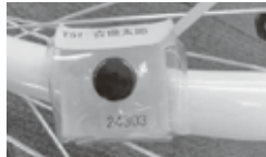
3) しっかり固定するまでタイラップを引き、タグがずれたり動いたりしないか確認します。
