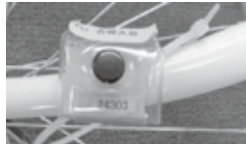
2) フロントホークに装着し、タイラップの細い先端を穴に通して強く引きます。
