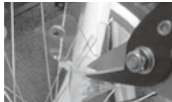
ケースの中にハサミを入れ、ケース内のタイラップを切断します。
